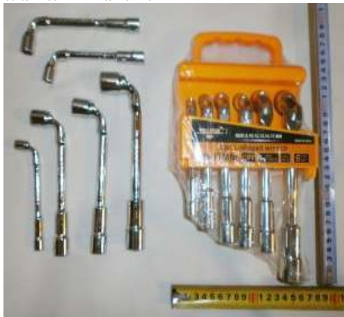
13347 SET 6 LLAVE EN L DE 8-10-11-12-14 Y 17 MM CROMO VANADIO STEEL N°45
