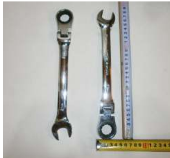
13345 LLAVE TRINQUETE AJUSTABLE Y FIJA 21 MM ACERO
