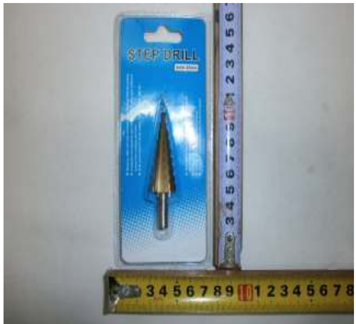
12578 MECHA ESCALONADA P/PERFORAR METAL DE 4 A 20MM
