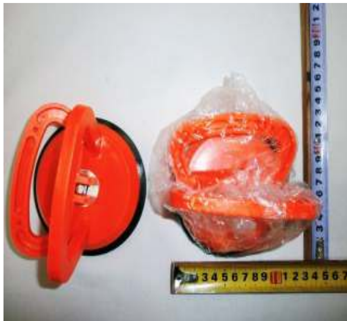
13238 VENTOSA GRANDE PARA SUJETAR VIDRIOS SOPORTA ENTRE 25 Y 30 KILOS
